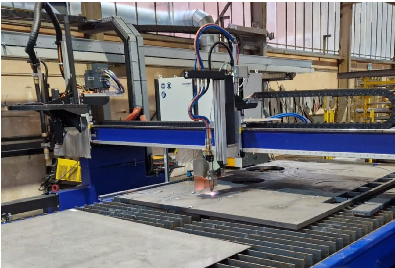
Bild 5: Der ALFA-Autogenbrenner schneidet effektiv bis zum Rand der Platte und sorgt dadurch für eine bessere Materialausnutzung. © Thöni Industriebetriebe GmbH
