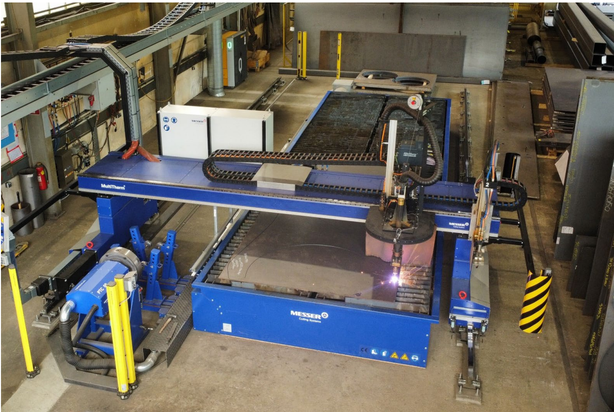
Bild 2: Die neue Brennschneidmaschine MultiTherm von Messer Cutting Systems mit Plasma-Fasenaggregat, ALFA-Autogenbrenner und Rohrschneidsystem. © Thöni Industriebetriebe GmbH
