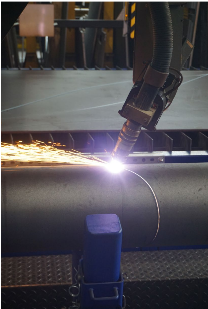
Bild 4: Mit dem Rohrschneidsystem PTC500 können Rundrohre mit bis zu 500 mm Durchmesser bearbeitet werden. Der Skew Rotator Delta sorgt dabei für exakte Fasen zur Schweißnahtvorbereitung. © Thöni Industriebetriebe GmbH
