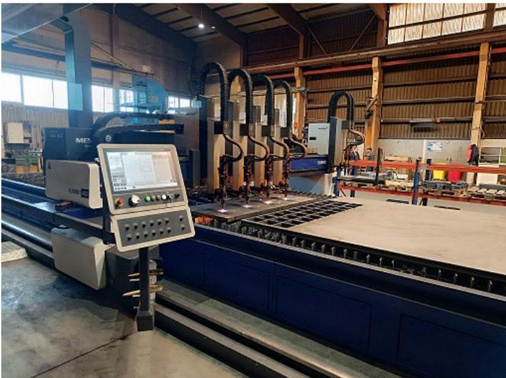
Bild 2: Die leicht zu bedienende Maschinensteuerung Global Connect an der ELEMENT mit Autogen-Maschinenbrenner ALFA und Absaugtisch. © Wagner Stahl
