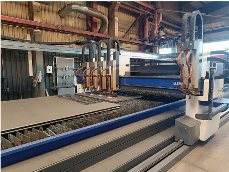
Bild 3: Vier der sechs Autogen-Maschinenbrenner ALFA an der ELEMENT im Einsatz. © Wagner Stahl
