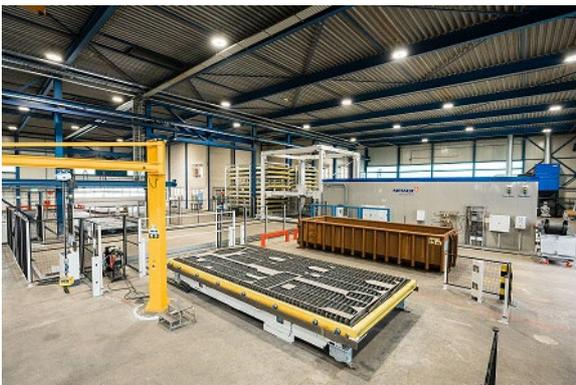
Bild: „Solutions Beyond Machines“ bei Joop van Zanten (Niederlande) mit Messer Cutting Systems PowerBlade mit Faserlaser-Technologie und OmniMat mit Plasma-Fasenschneiden, OmniFab-Digitalisierungslösung, OmniWin CAD/CAM-Software, Material Handling System.
