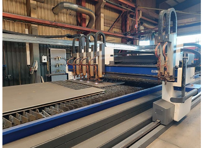
Bild 1: Vier der sechs Autogen-Maschinenbrenner ALFA an der ELEMENT im Einsatz, © Wagner Stahl
