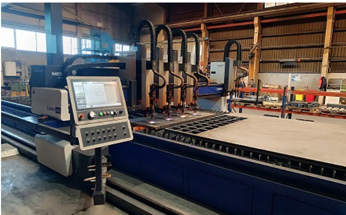
Bild 2: Die leicht zu bedienende Maschinensteuerung Global Connect an der ELEMENT mit Autogen-Maschinenbrenner ALFA und Absaugtisch, © Wagner Stahl
