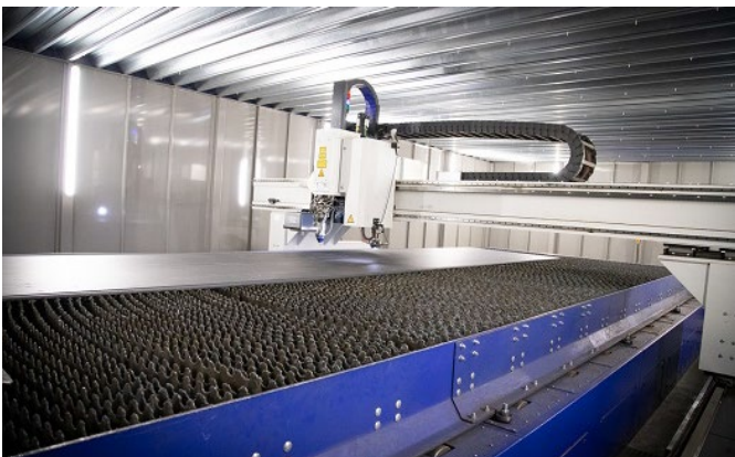
Caption: The PowerBlade laser machine with 6kW bevel cutting head and OmniScript pin marker. © CHEMET Spółka Akcyjna
