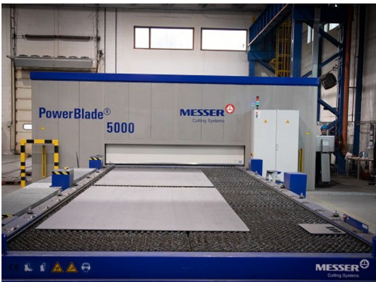
Bild 1: Die Lasermaschine PowerBlade mit Umhausung in der neuen Produktionshalle in Tarnowskie Góry © CHEMET Spółka Akcyjna
